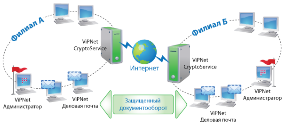
Рисунок 1: Схема сети ViPNet - электронный документооборот
