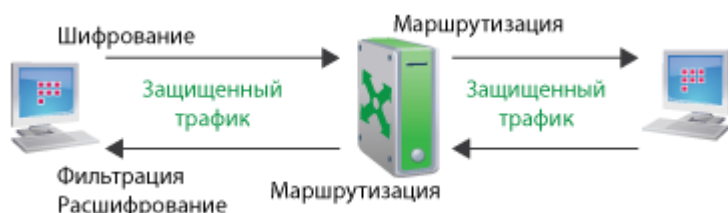
Рисунок 4: Обмен информацией между узлами ViPNet Client
