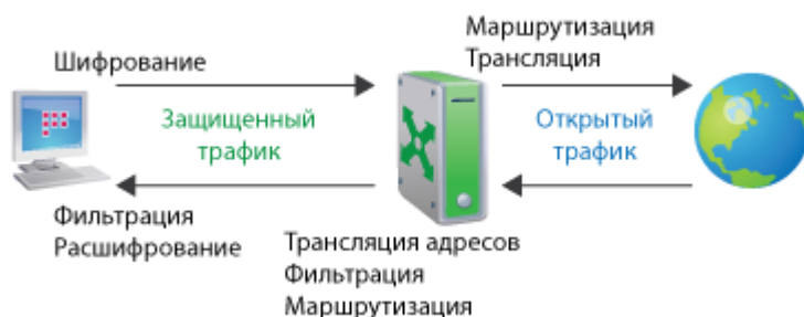
Рисунок 5: Обмен информацией между узлом ViPNet Client и Интернетом
