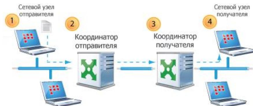
Рисунок 1: Передача конверта через свой координатор
