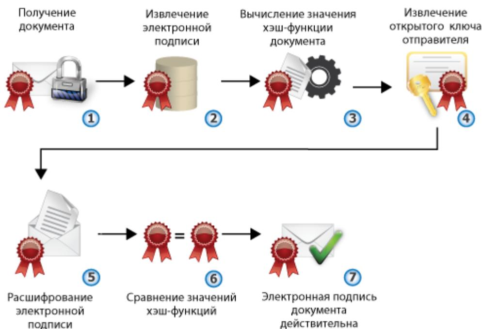
Рисунок 51: Процесс проверки подписи
