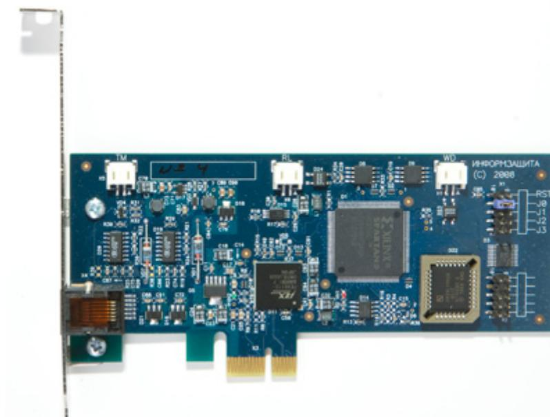
**Рис. 4. Плата комплекса "Соболь 3.0" для шины PCI-E**
