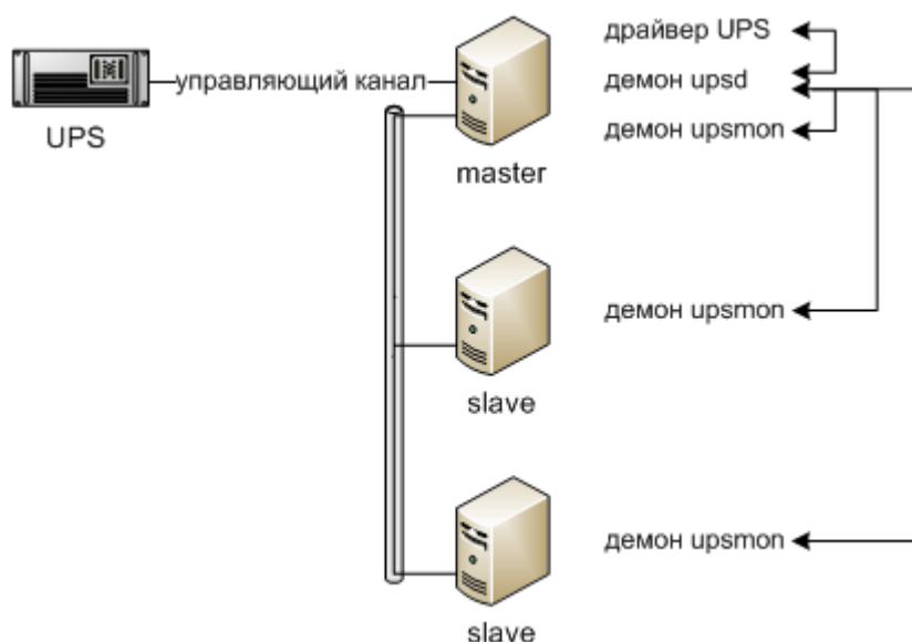
Рисунок 32: Схема взаимодействия ПАК с UPS
