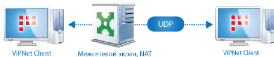
Рисунок 28: Сетевые узлы соединяются через межсетевой экран
