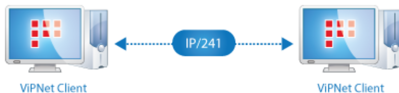
Рисунок 27: Сетевые узлы расположены в одном сегменте локальной сети
