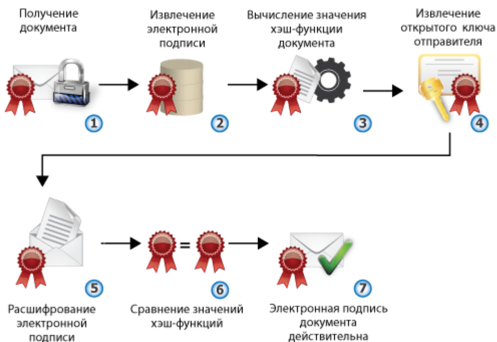
Рисунок 146: Процесс проверки подписи
