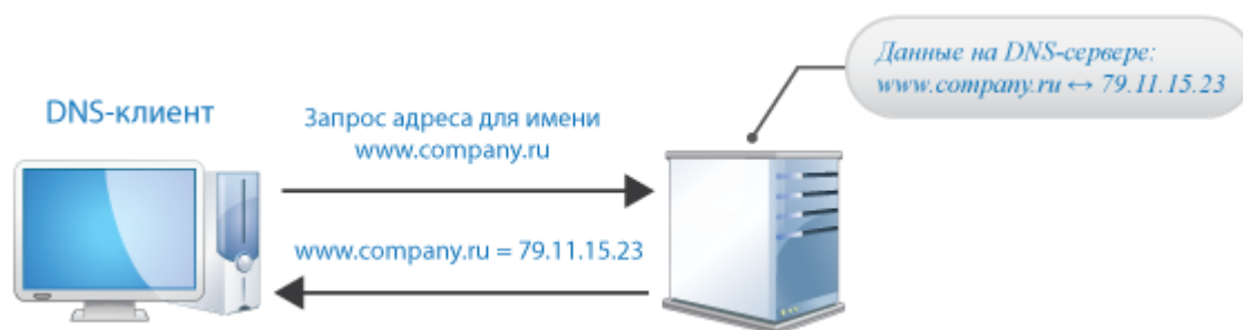
Рисунок 37: Общий принцип работы службы DNS
