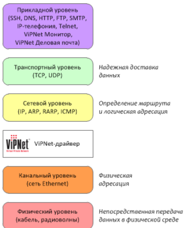
Рисунок 1: ViPNet-драйвер в модели OSI
