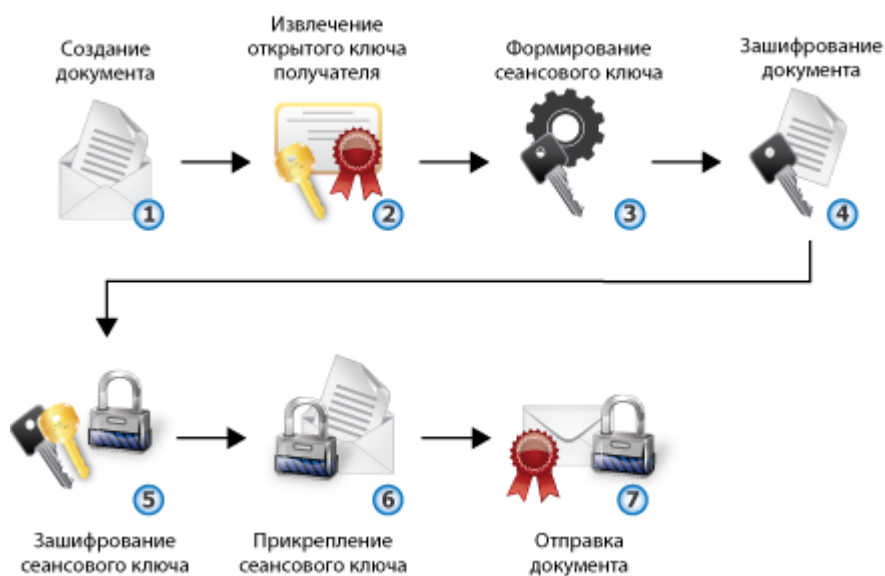
Рисунок 143: Процесс зашифрования электронных документов
