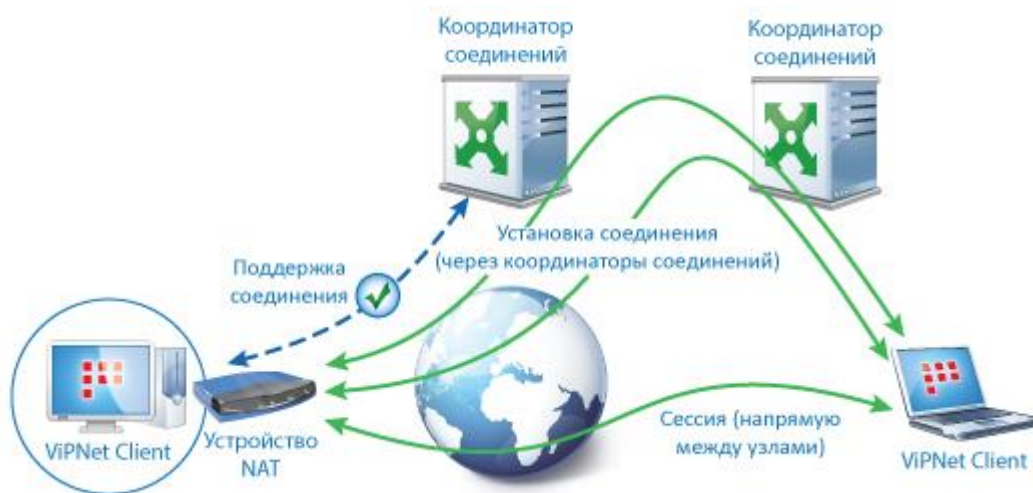
Рисунок 30: Взаимодействие между сетевыми узлами
