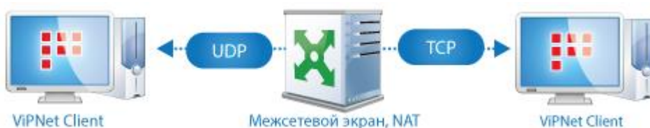
Рисунок 29: Сетевые узлы соединяются через межсетевой экран
