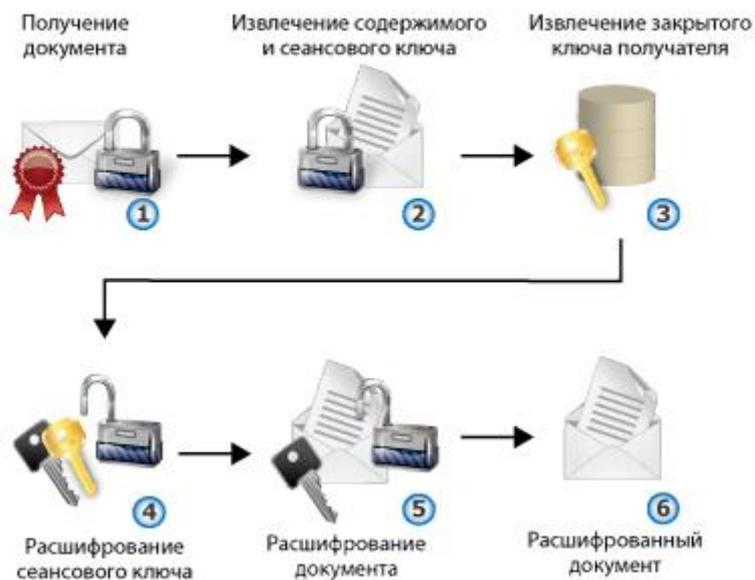
Рисунок 182: Процесс расшифровки электронных документов
