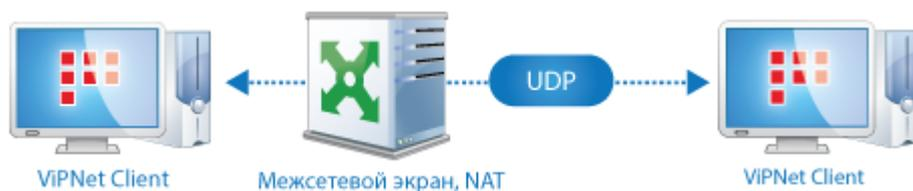
Рисунок 35: Сетевые узлы соединяются через межсетевой экран
