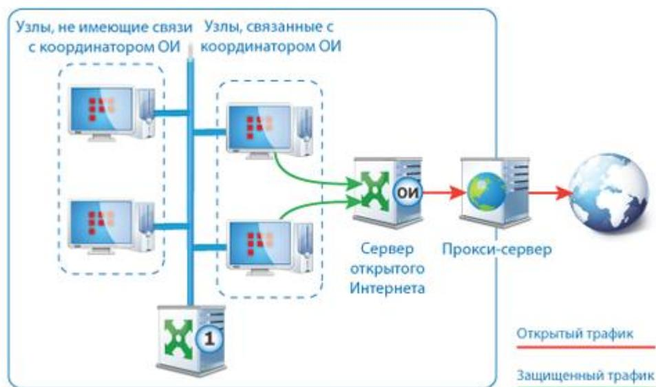
Рисунок 103: Технология «Открытый интернет» с выделенным прокси-сервером
