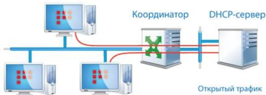
Рисунок 106: Транзитный DHCP-сервер
