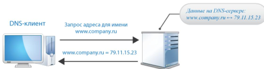
Рисунок 52: Общий принцип работы службы DNS
