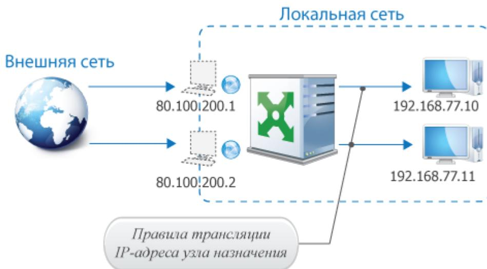
Рисунок 92: Доступ к внутренним ресурсам при помощи правил трансляции IP-адресов узлов назначения
