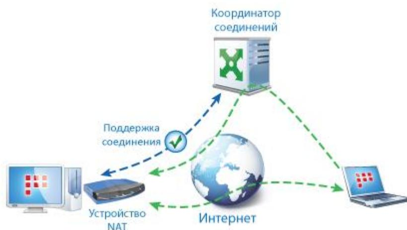
Рисунок 8: Организация соединений между сетевыми узлами ViPNet
