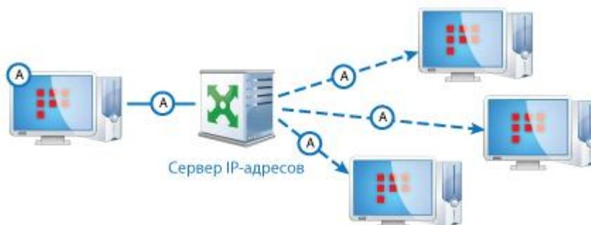
Рисунок 6: Роль сервера IP-адресов в сети ViPNet
