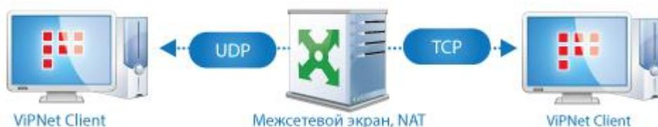
Рисунок 36: Сетевые узлы соединяются через межсетевой экран
