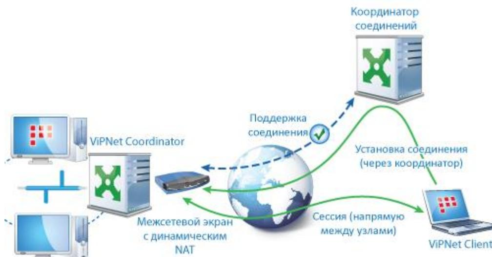
Рисунок 42: Подключение через межсетевой экран с динамической трансляцией адресов
