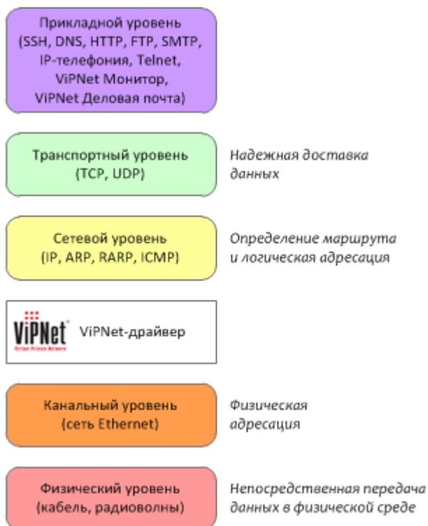
Рисунок 4: ViPNet-драйвер в модели OSI
