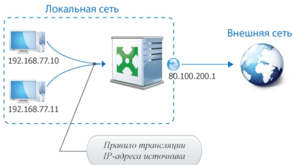
Рисунок 93: Организация доступа в Интернет при помощи правила трансляции IP-адреса источника
