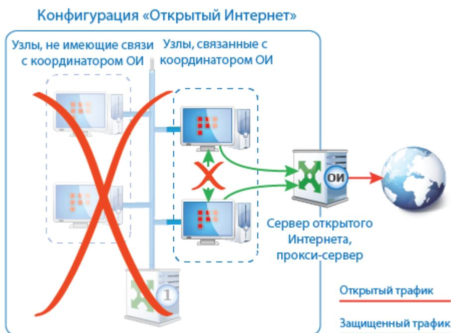
Рисунок 104: Схема работы в режиме «Открытый Интернет»
