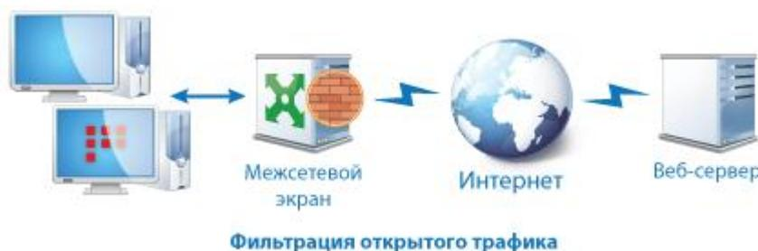
Рисунок 11: Роль межсетевого экрана в сети ViPNet
