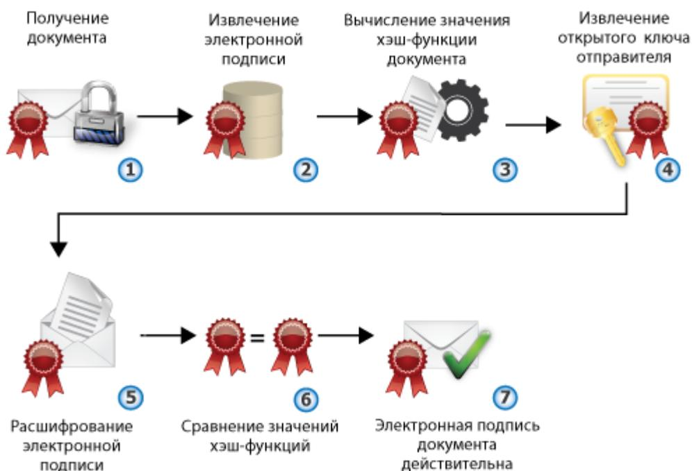
Рисунок 184: Процесс проверки подписи
