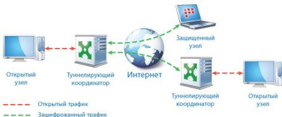
Рисунок 9: Использование туннелирования в сети ViPNet
