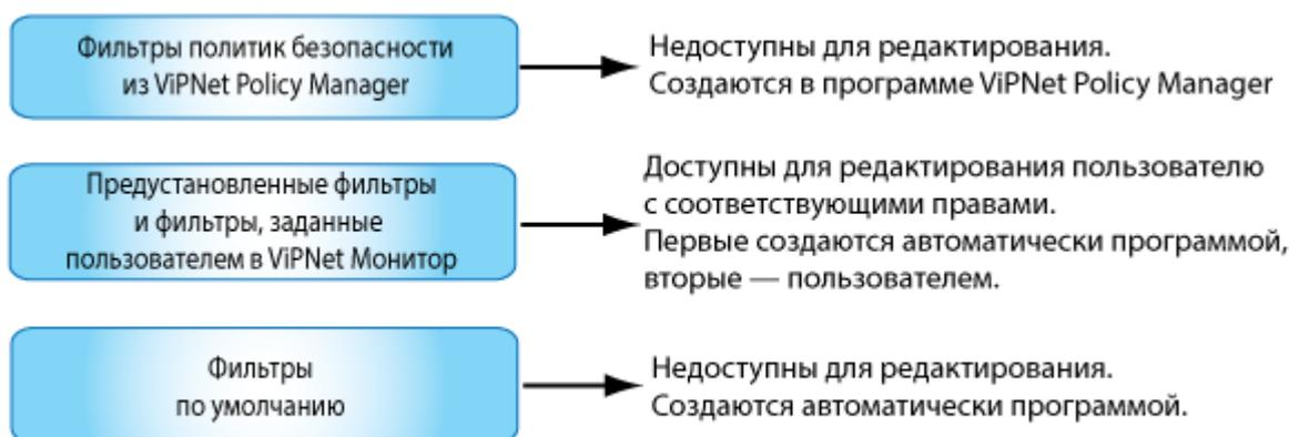
Рисунок 59: Приоритет применения сетевых фильтров
